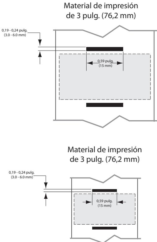
**Figura 8: Instalación del material de impresión**
